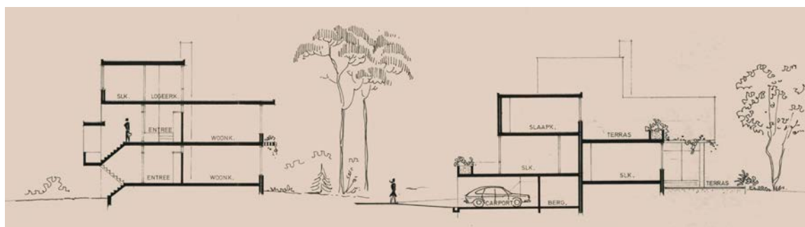
Doorsnede van de split-levelwoningen en de collectieve tuin in het midden, 1972. Bron: Archief Eemland.
