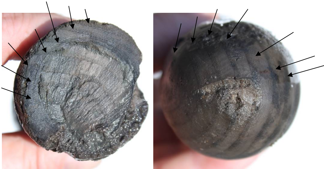
Figuur 12 Eendragt, links: onderkant van handvat ter hoogte van aanzet pen, rechts: rond afgewerkt uiteinde (kop) van handvat. Op beide foto's zijn duidelijk de wijde jaarringen van het essenhout te herkennen (pijlen).
