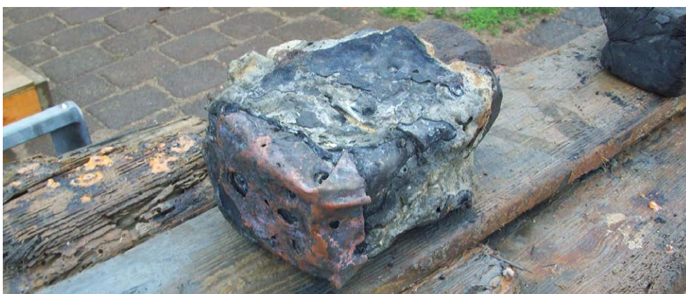
Afb. 5.6 Gedeelte van een houten balk met afdekking van koperen en loden platen (bron: W. Bakker)
