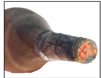
Afb. 6.42 Detail van het uiteinde van de remstok (vnr 14) met corrosie en mogelijke touwresten; uiteinde (a), zijkant (b) (Bron: Lange 2018).
