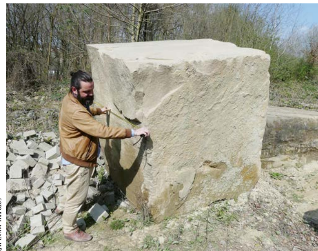
In de groeve wordt gekeken naar de kwaliteit van de steen en de afmetingen van de blokken
