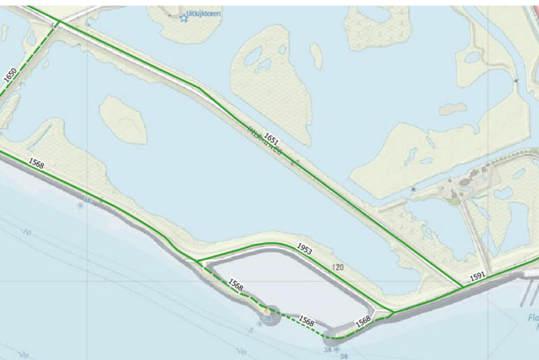
Afb. 3.6 Flauwers Inlaag Schouwen-Duiveland, fragment van de RCE-dijkenkaart. Hier liggen zowel een oude, preventief aangelegde inlaagdijk (uit 1651) als een inlaagdijk die aangelegd is ter reparatie van een doorbraakgat van de ramp van 1953. Een flink deel van het door de dijken beschermde agrarisch gebied is sinds 2004 omgezet in natte natuur.
