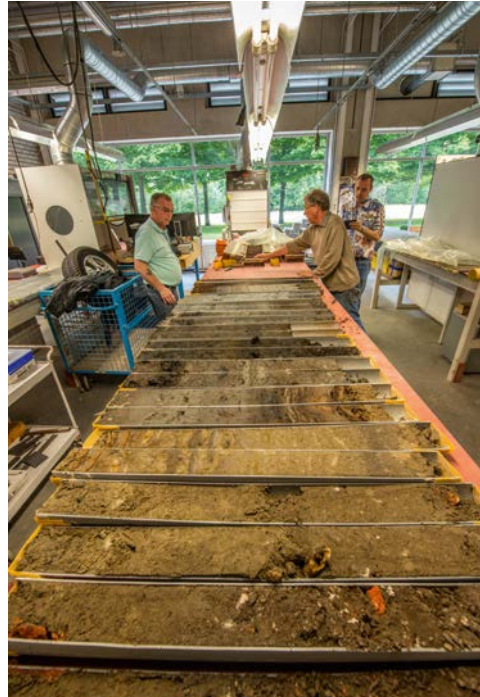
Afb. 2.13 Op een tafel uitgelegde doorsgesneden boorkernen van de terp van Hogebeintum. De kernen laten fraai de gelaagde opbouw zien (foto: J. Stöver).
