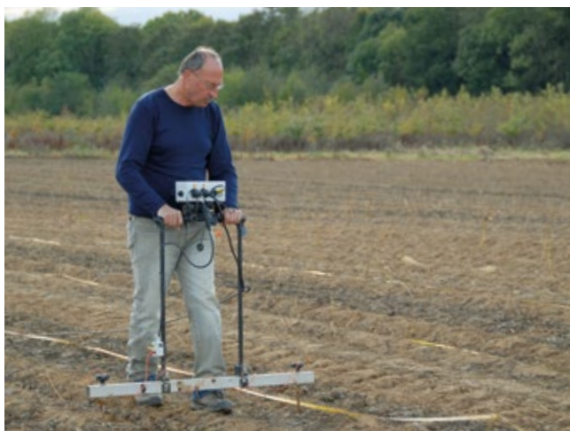
Een weerstandsmeter verstoort de ondergrond niet
