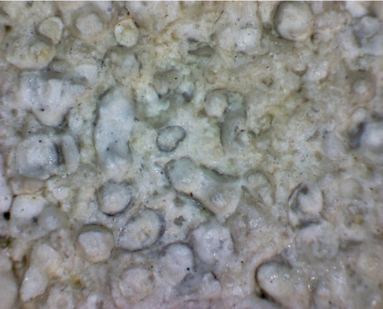
Euville met calcietcement nog grotendeels intact.
