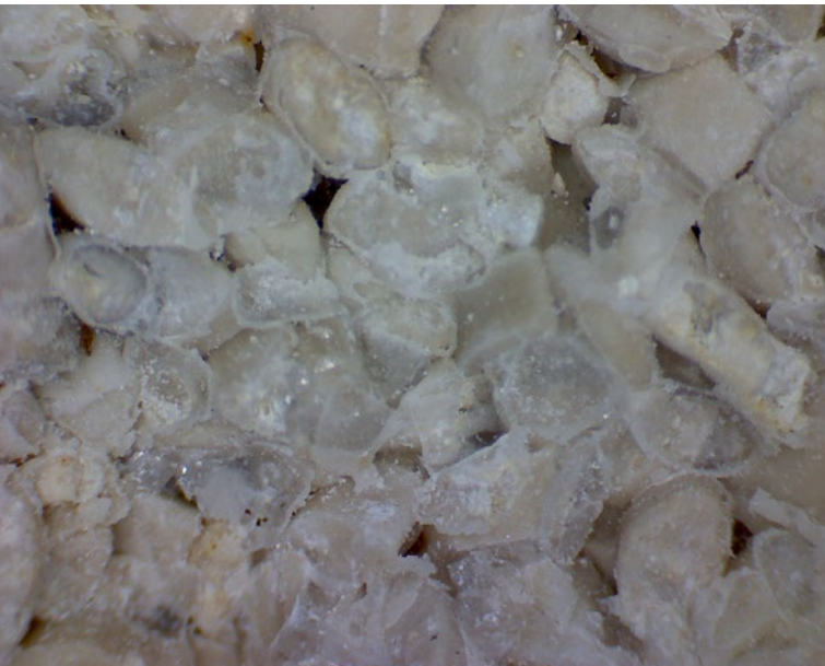
Euville met calcietcement fors aangetast.
