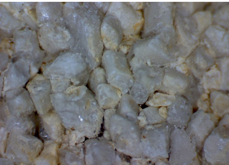
Euville waarvan de calcietcementering vrijwel is verdwenen.
