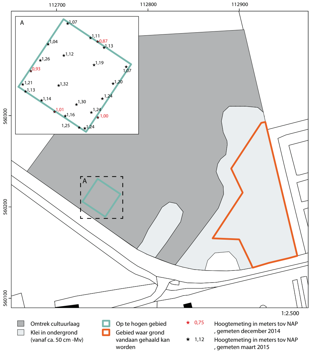
Afb. 18 Wederophogingsplan en hoogtemetingen voor en na de ophoging.
