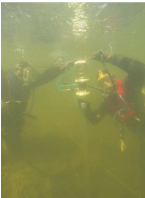
Afb. 4.8 De Vibrocore in gebruik. Er waren twee duikers nodig om de boor te bedienen, zowel boven het water als ook onder water.
