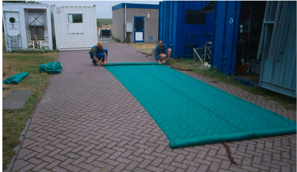
Afb 12: Het prepareren van het afdekgaas. Aan beide zijden worden oude wekkerkettingen (kettingen die bij de boomkorvisserij worden gebruikt) in het gaas vastgezet. Daarna wordt het gaas opgerold (foto A. Vos, 2002).
