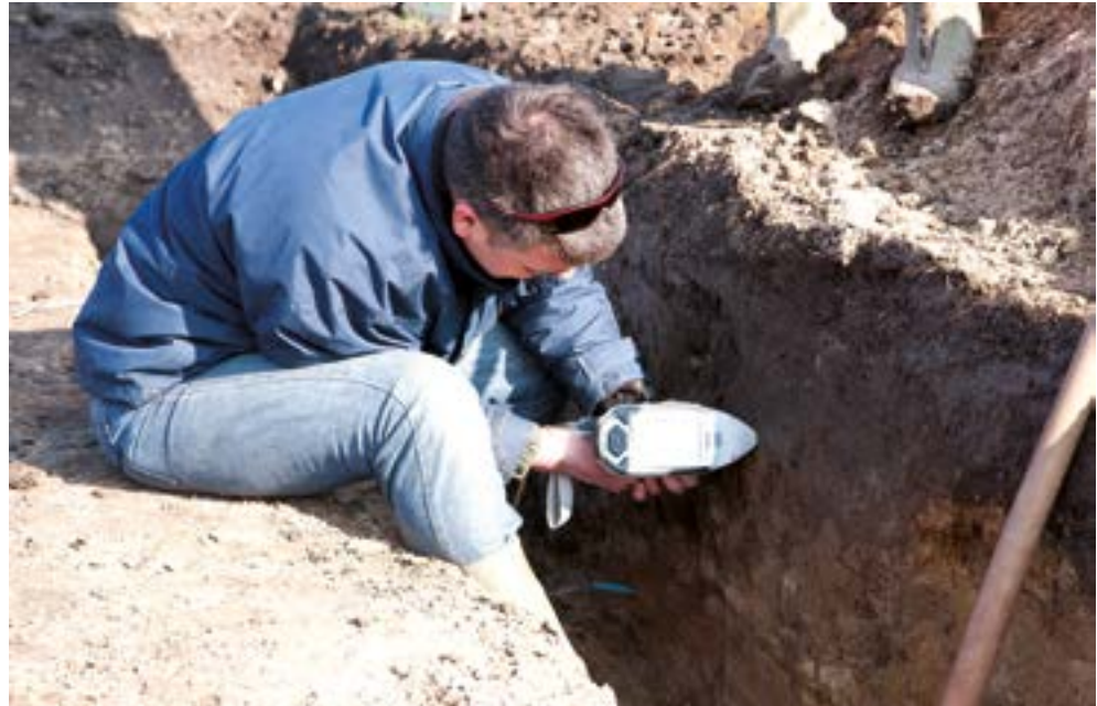
Afb. 3.2: XRF-metingen aan het profiel.
