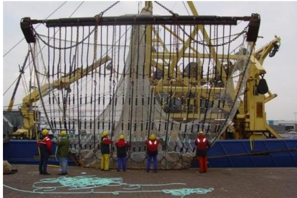
Afbeelding 16: visnetten met daaraan de pulsmodules bevestigd.
