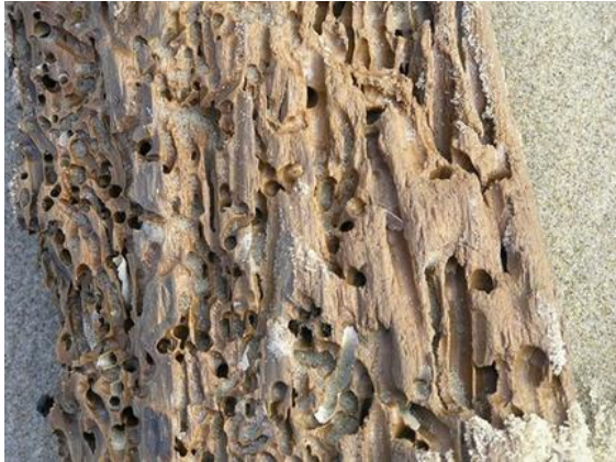
Afbeelding 9: door paalworm aangetast hout.
