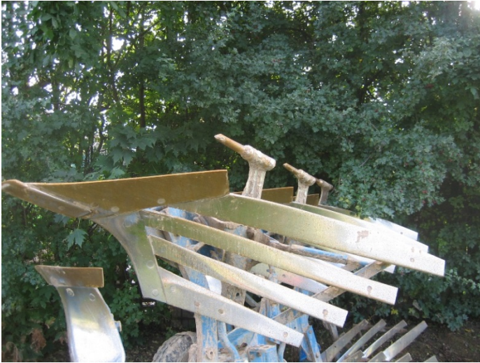
Foto 10. Penvormige ondergronders gemonteerd onder de ploeglichamen.
