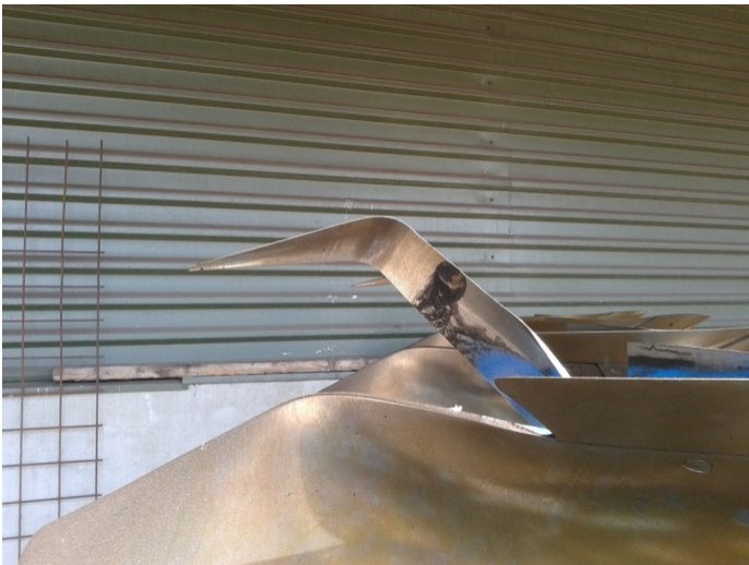
Foto 11. Mesvormige ondergrondwoeler, gemonteerd onder het eerste ploeglichaam.
