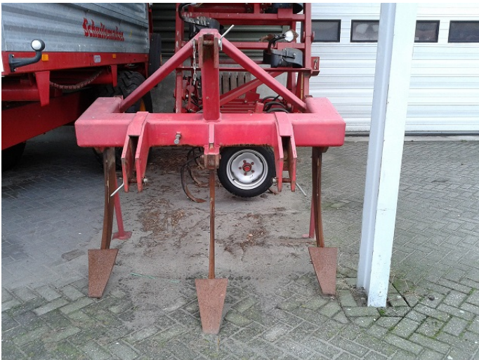
Foto 11. Mesvormige ondergrondwoeler, gemonteerd onder het eerste ploeglichaam.
