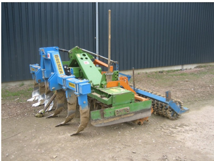
Foto 16. Combinatie van voorzetwoeler, rotorkoepel, drukrol en verkruijmelrol.
