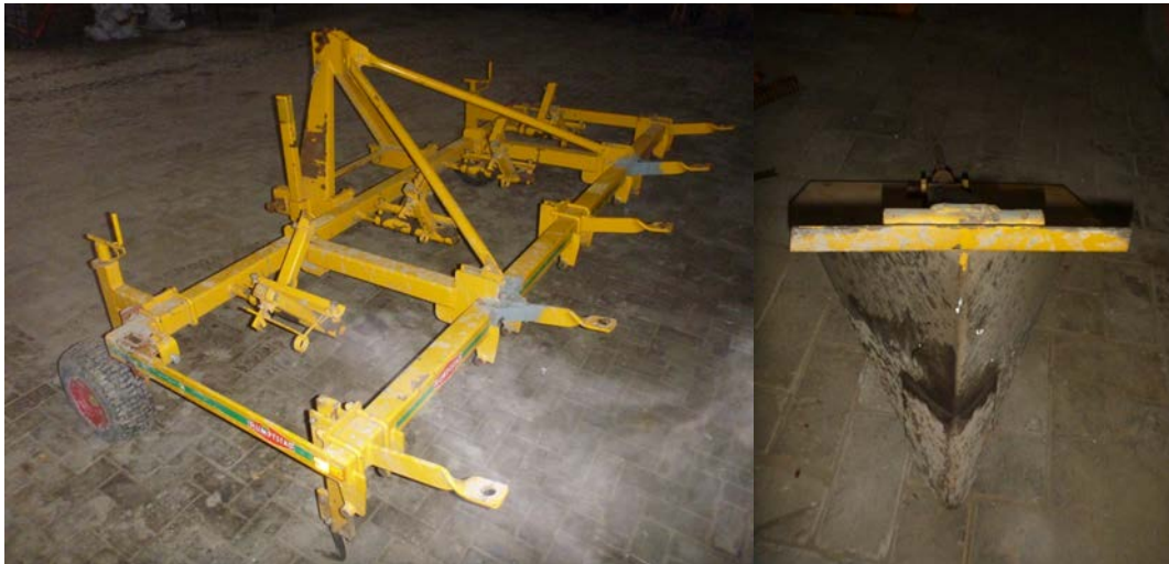
Foto 9. Werktuigraam (links) waarin aanaarders (rechts) gemonteerd kunnen worden.
