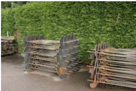
Foto 27. Grondankers voor verstevigen van de hagelnetconstructie.
