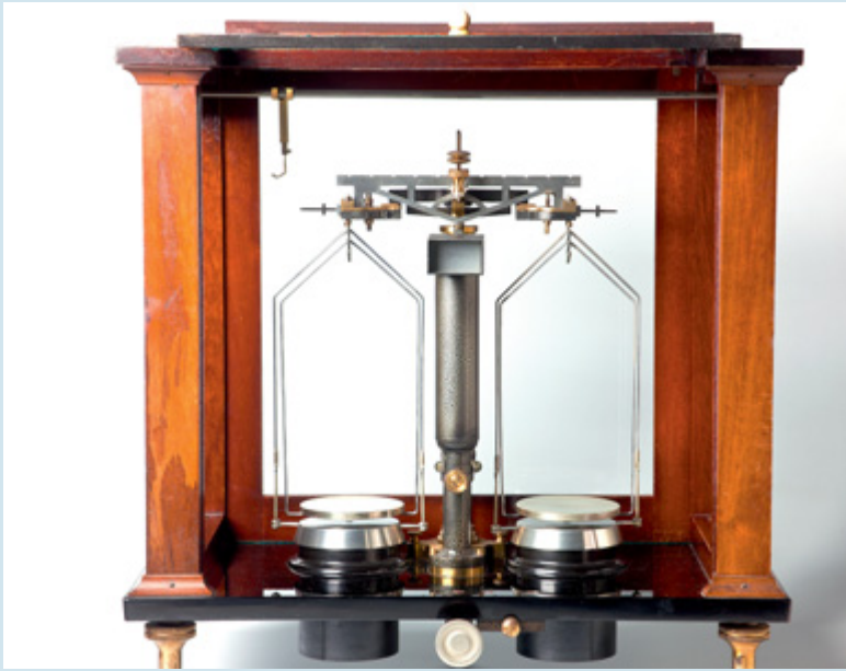
Chemische precisiebalans, tot 1950 gebruikt in het laboratorium van papierfabriek Van Gelder
