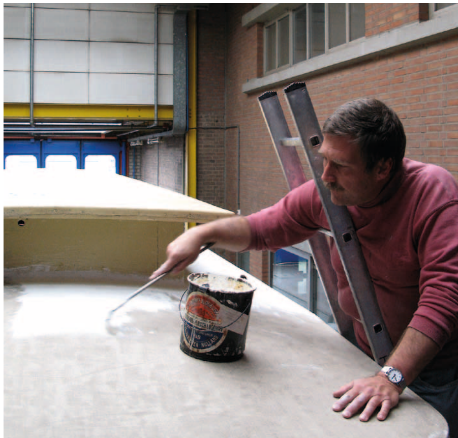
Tramrestaurator Thonis van der Weel impregneert een linnen dakbedekking met verf
