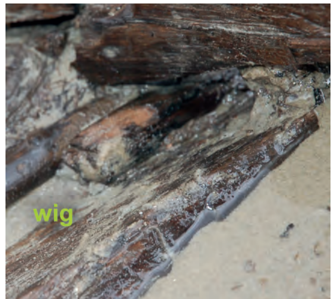
Afb. 10 (boven) Het bakboord, 6 m uit de voorkant, met tussen de tweede en bovenste (overlappende) gang mosbreeuwsel, een ronde 'moslat' en een wig om deze op zijn plaats te houden. (rechts) Detail van de wig die tussen de moslat en het kromhout is vastgeslagen. Foto's RCE.
