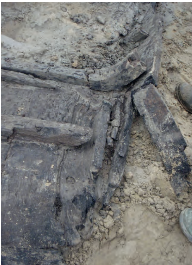
Afb. 8 Kimplank met hiertegenaan het bakboord. Gezien vanaf het voorschip. Foto RCE.
