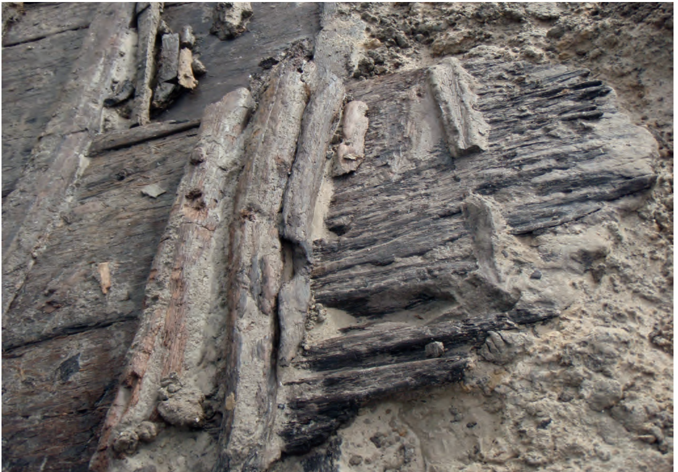
Afb. 6 Detailopname van de resten van de stevenplaat in het voorschip. Foto RCE.
