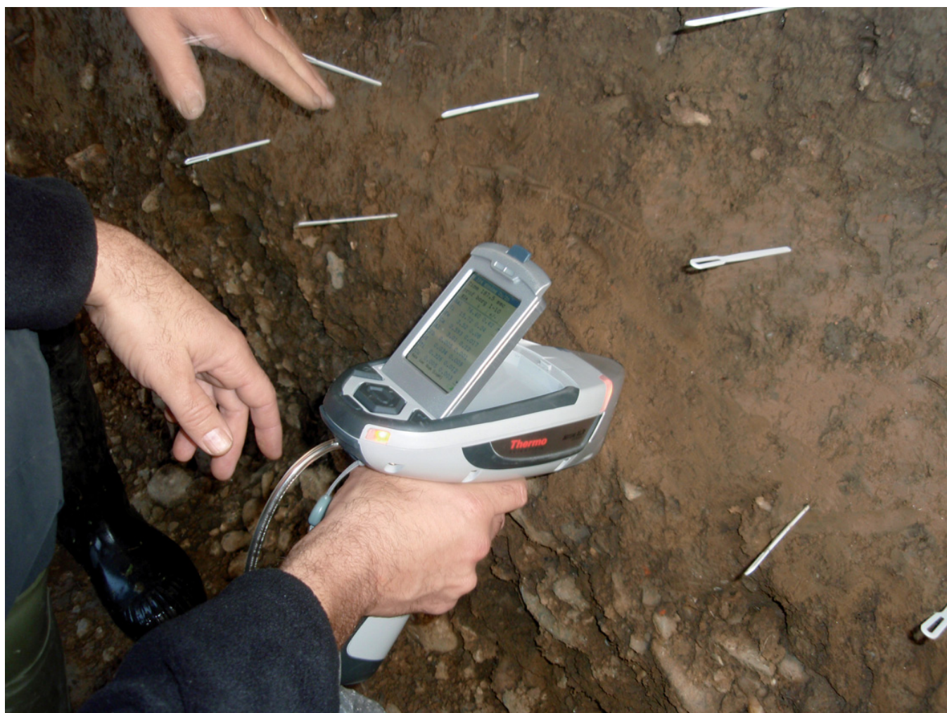
Afb. 6 Gebruik van de hand held XRF in het veld.
