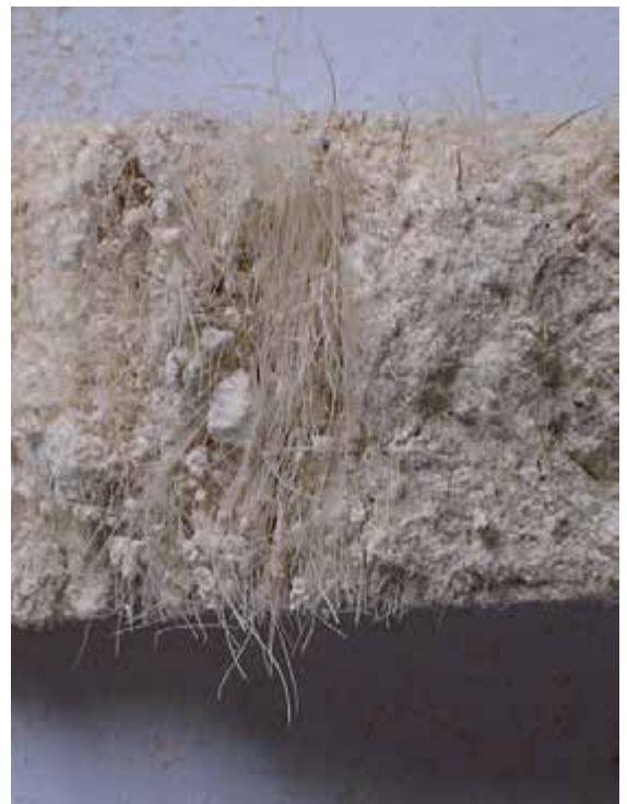
9. Abdij van 't Park, refectorium. Monster van de raaplaag met talrijke dierlijke vezels (haren) (foto auteur)
