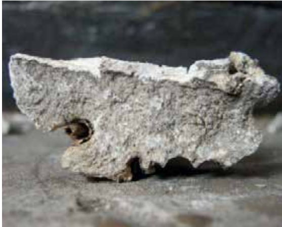
4. Stucmonster van de noordwand. Aan de onderzijde zijn de afdrukken van de rietstengels zichtbaar, aan de bovenzijde de lichtgekleurde dunne pleisterlaag (foto auteur)
