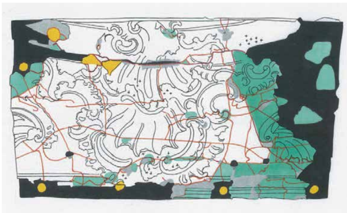
15. Opmetingstekening met aanduiding van de verschillende schades van een van de randornamenten van de Beuningkamer (tekening K. Keutgens)
