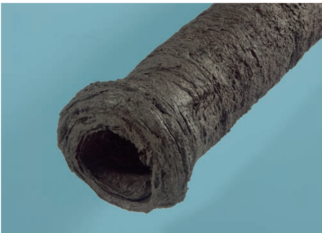
Afb. 71 Blik op de versterkte vuurmond. De ziel meet (thans) ca. 4,5 cm. Let in het voorvlak van de tromp op de naad tussen de lengtestaven en het rondgesmede werk. (Foto: Ton Penders, Rijksdienst voor het Cultureel Erfgoed)
