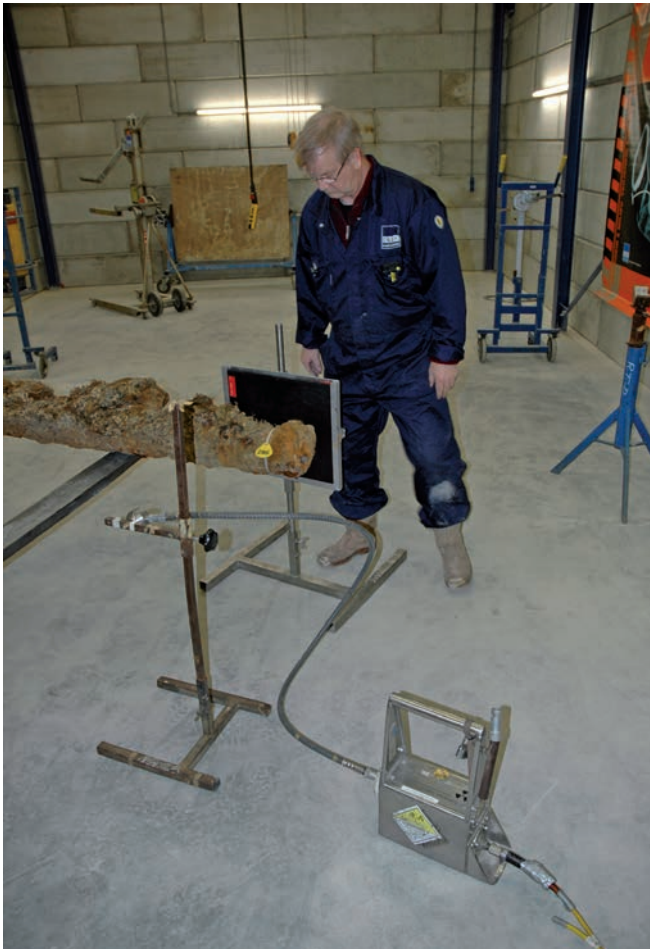
Afb. 35 Opstelling voor een opname bij de Röntgentechnische Dienst in Rozenburg. (Foto: Arent Vos, Rijksdienst voor het Cultureel Erfgoed)
