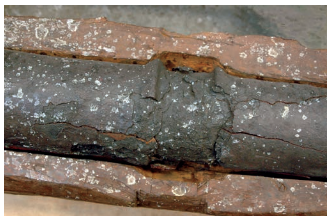
Afb. 93 Over de hele lengte van de loop is een ca. 1,5 cm dikke laag van het oppervlakte losgekomen van de kern en in steeds kleinere delen aan het brokkelen. (Foto: Arent Vos, Rijksdienst voor het Cultureel Erfgoed)
