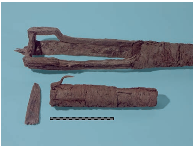
Afb. 64 Kanon Rit-018, na gloeien en stralen. Er zijn nu veel meer details zichtbaar. (Foto: Ton Penders, Rijksdienst voor het Cultureel Erfgoed)
