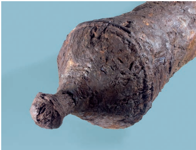
Afb. 81 Een gefacetteerde kulas en op de grootste omtrek een kulasband. Let ook op de constructie van de druif, een staafsmeedijzer op het uiteinde waarvan een ander stuk smeedijzer is rondgeweld. (Foto: Ton Penders, Rijksdienst voor het Cultureel Erfgoed)
