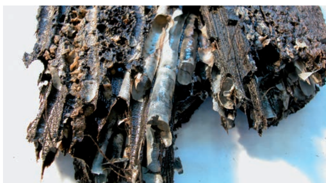
Afb. 24 en 25 Voorbeelden van aantasting door paalworm. Na verloop van luttele jaren kan een dikke eiken balk die vrij ligt op de zeebodem volledig door dit dier zijn opgegeten. Met zijn schelpje raspt hij zich een weg door het hout. (Foto's: Arent Vos en Hans Schraal, Rijksdienst voor het Cultureel Erfgoed)
