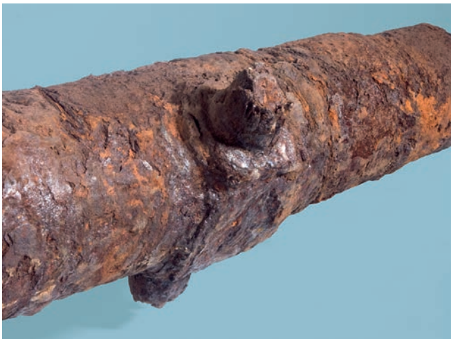
Afb. 82 Aanzet en bevestiging van de tappen, een blik op de onderkant. (Foto: Ton Penders, Rijksdienst voor het Cultureel Erfgoed)
