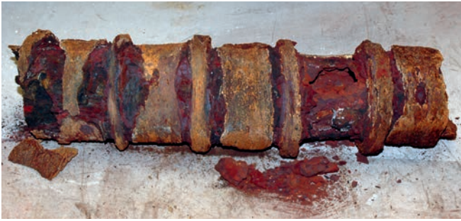
Afb. 60 Kanon Rit-017. Na het gloeien is de concretielaag vanzelf losgekomen, maar het onderliggende ijzer blijkt in deplorable conditie. (Foto: Arent Vos, Rijksdienst voor het Cultureel Erfgoed)
