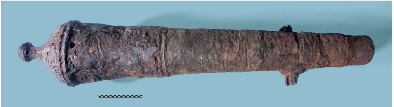
Afb. 80 Kanon Rit-020 voor gloeien en stralen, maar zelfs zo al zijn de rondgesmede hoepels te onderscheiden. (Foto: Ton Penders, Rijksdienst voor het Cultureel Erfgoed)
