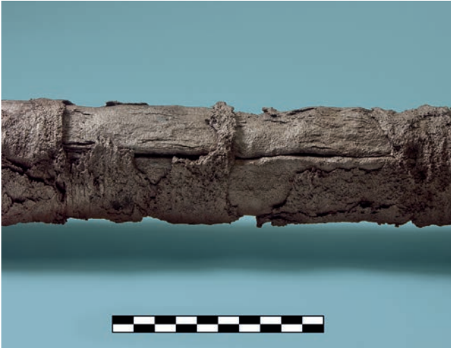
Afb. 70 Kanon Rit-017. Blik op de kern van de loop, opgebouwd uit slechts twee brede hol/bol gesmede staven in de lengterichting. Let op de welnaden van de hoepels. (Foto: Ton Penders, Rijksdienst voor het Cultureel Erfgoed)
