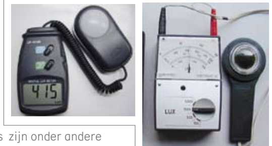
Fig. 10.1 Verschillende typen luxmeters met losse fotocel; links digitaal, rechts analog
