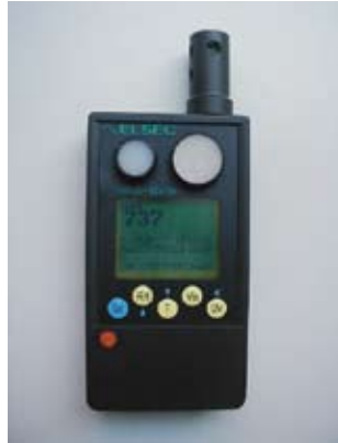
Fig. 10.3 Voorbeeld van gecombineerde handmeter voor verlichtingssterkte, UV-gehalte, temperatuur en relatieve luchtvochtigheid, de vier grootheden die musea willen meten (Elsec 764)
