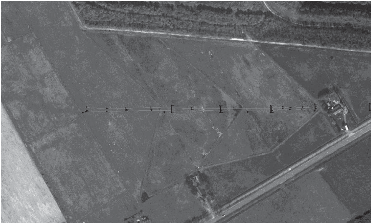
Afb. 4 In 1991 zijn drie V-vormige leidammen op het monument aangelegd om het regenwater wat langer vast te houden. Daarop geprojecteerd is het verloop van de weg, gebaseerd op de resultaten van de prikactie in maart 2004.
