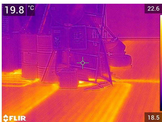
Afbeelding 37. Objecten op een vloer met vloerverwarming dekken de vloer op die plek af. Hierdoor zal de temperatuur onder het object (of in de vitrine) stijgen (foto's: Bart Ankersmit).
