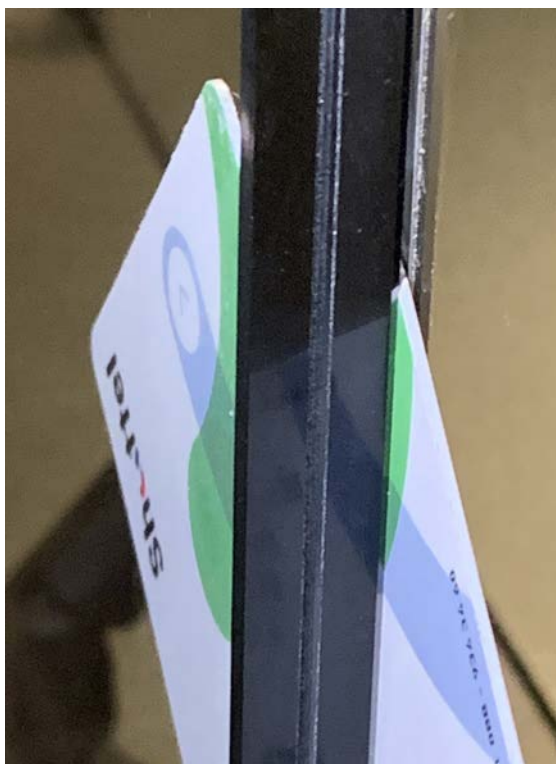
Afbeelding 12. Als een plastic (bank)pasje zonder veel druk tussen twee glasplaten geschoven kan worden, zal de spleet minimaal 760 \mu\text{m} zijn (foto: Bart Ankersmit).
