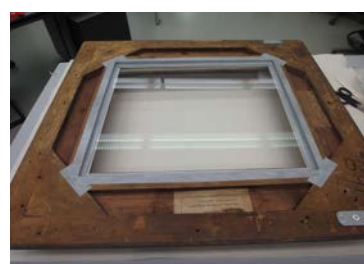
3. Met behulp van de aluminium tape wordt voorkomen dat lucht via de voorzijde langs de glasplaat naar binnen kan lekken.
