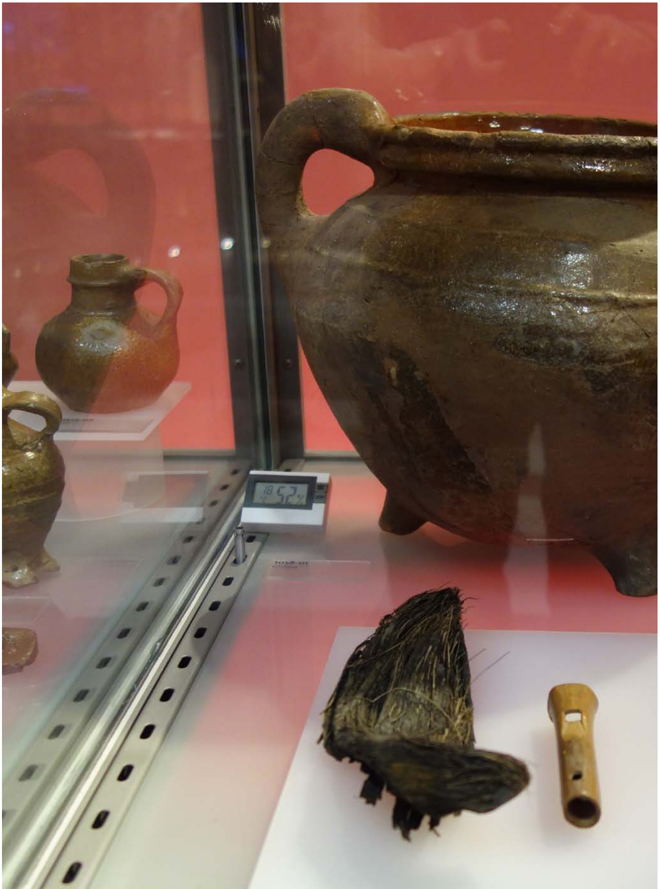
Een vitrine kan geklimatiseerd worden, waardoor die klimatologisch ontkoppeld is van het omringende, ruimtelijke klimaat. Dat biedt mogelijkheden om het ruimtelijke klimaat minder streng te regelen, waardoor energie wordt bespaard (foto: Bart Ankersmit).
