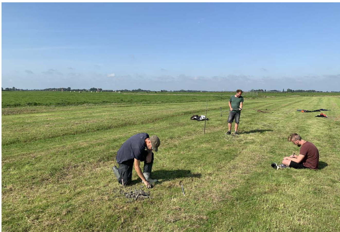
Afb. 4.1 Een impressie van het booronderzoek in september 2020 in de Lionserpolder. Op de achtergrond worden de opgeboorde lagen beschreven, die de persoon rechts in Deborah op de veldcomputer zet. Op de voorgrond wordt een al beschreven boorkern weer teruggestopt in het boorgat.
