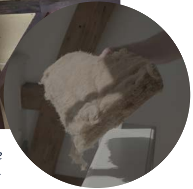
Het dak is geïsoleerd met jute en houtvezelplaten.
