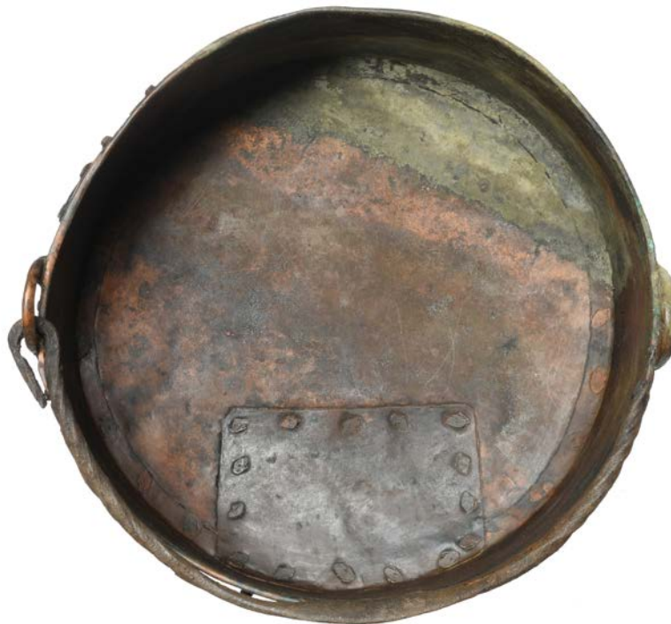
Afb. 54. Detail Koperen ketel (vondstnummer 32): reparatie van de bodem (Bron: Restaura).
