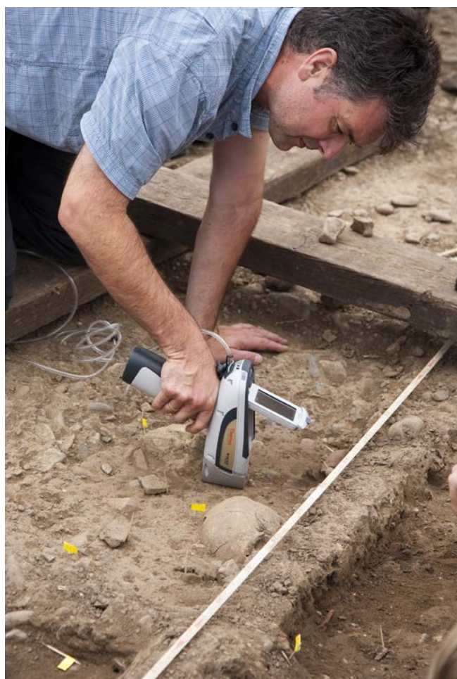
Afb. 2 Een voorbeeld van een techniek afkomstig uit de aardwetenschappen, het uitvoeren van XRF-onderzoek tijdens archeologisch veldwerk.
