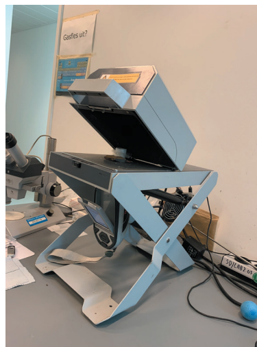
P-XRF analyse van een koperplaat uit een scheepswrak in een depot.
