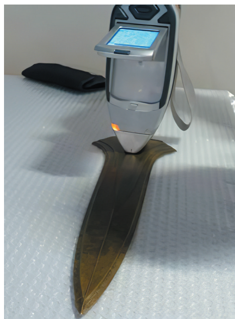
P-XRF analyse van het zwaard van Ommerschans, foto: Rijksmuseum van Oudheden.
