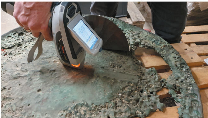
P-XRF analyse van een koperplaat uit een scheepswrak in een depot.
