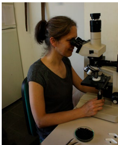
Met een houtskoolmicroscop worden de objecten met strijklucht bekeken bij vergrotingen tot 400x. Foto: BIAX Consult / Silke Lange
