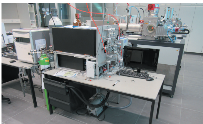
AMS (Accelerator Mass Spectrometer) van de Rijksuniversiteit Groningen voor het meten van ^{14}\text{C} concentraties, foto: H. van der Plicht.
