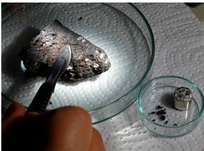
Het bemonsteren van organisch residu (aangekoekte voedselresten) voor SEM-analyse, door kleine fragmenten residu te monteren op zogenaamde SEM-steuntjes. Foto: L. Kubiak-Martens, BIAx Consult.
