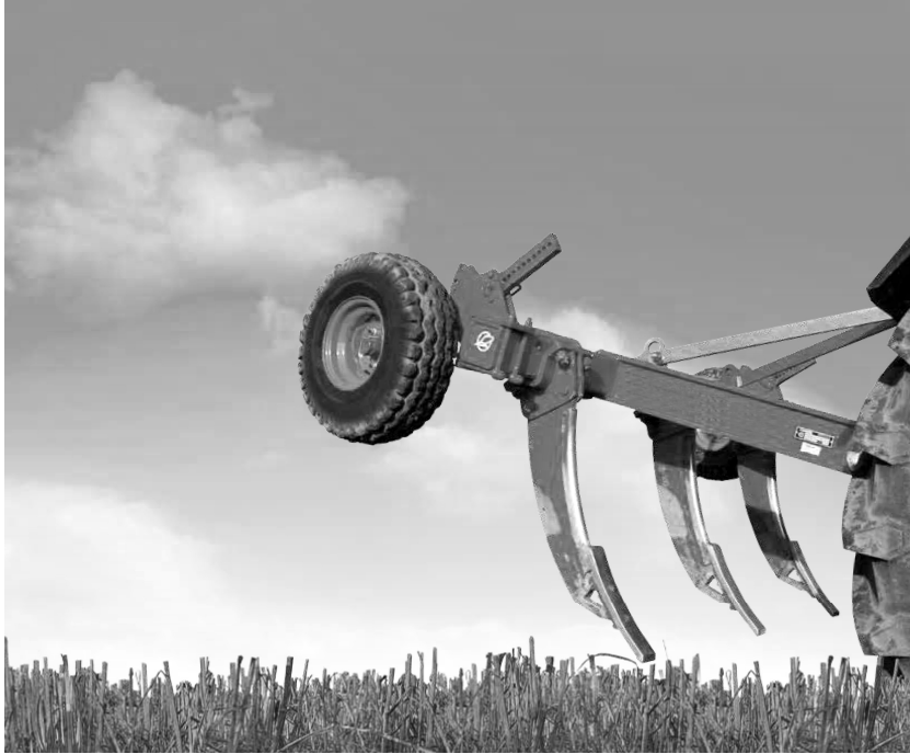
Figuur 5. Een cultivator/ ondergronder voor het tot 65 cm diep decompacteren van de verdichte ondergrond (foto: Lemke Gmbh/Labrador).
