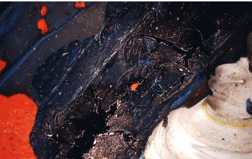
Omdat deze verf nooit goed is gedroogd is er vuil in vastgekoekt, die moeilijk zonder beschadigingen te verwijderen is
