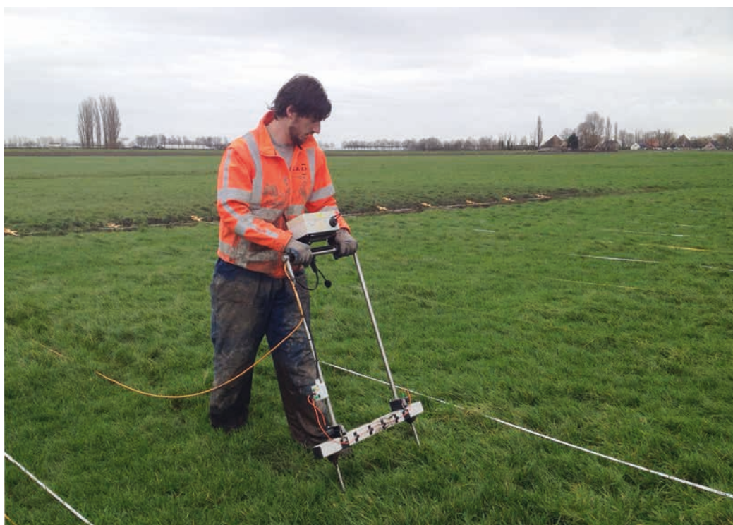
Een onderzoeker bij Wervershoof aan de slag met een elektrische-weerstandmeter
