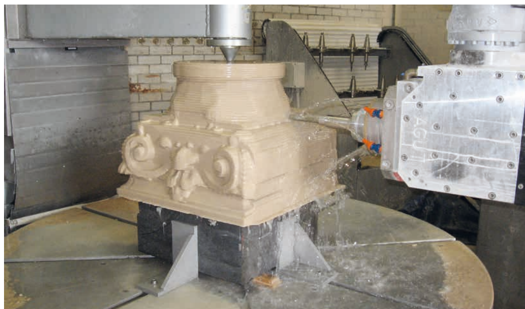
Digitaal aangestuurde CNC-freesmachines zijn onderdeel van restauratiewerk geworden
