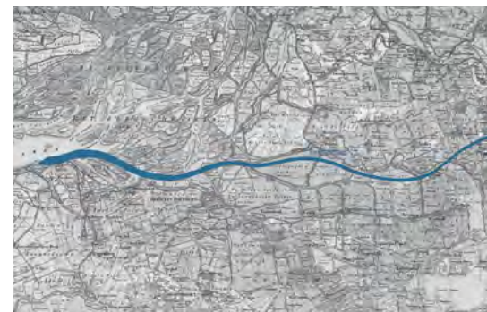
Bij Heusden werd de Maas afgedamd. Vanaf voerde een nieuwe waterloop - ruim 170 meter breed en hemelsbreed 20 kilometer lang - het Maaswater naar de Amer af.
