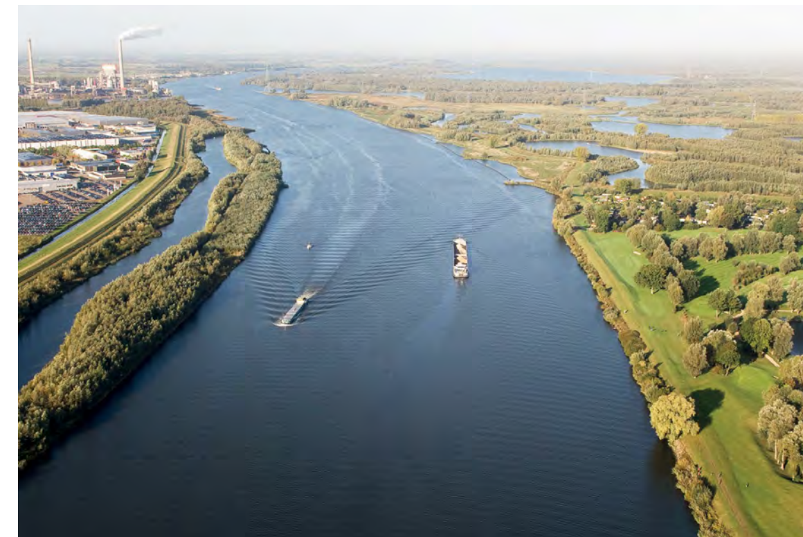
De Bergse Maas. De rivierbedding is niet recht gegraven, maar van flauwe bochten voorzien, zodat de rivier minder snel verzandt. Bovendien zijn er, net als bij een 'echte rivier' uiterwaarden aangelegd. Bron: Rijkswaterstaat.
