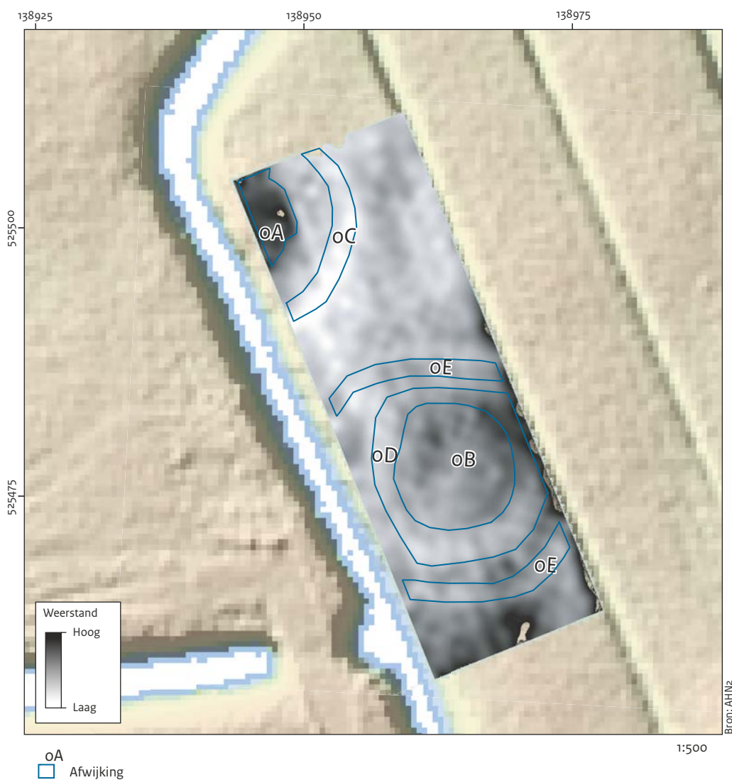
Afb. 8.2 De resultaten van het elektrisch weerstandsonderzoek in zone 0 ( gradual shade ) op een ondergrond van het AHN. De waargenomen afwijkingen zijn in blauw.
