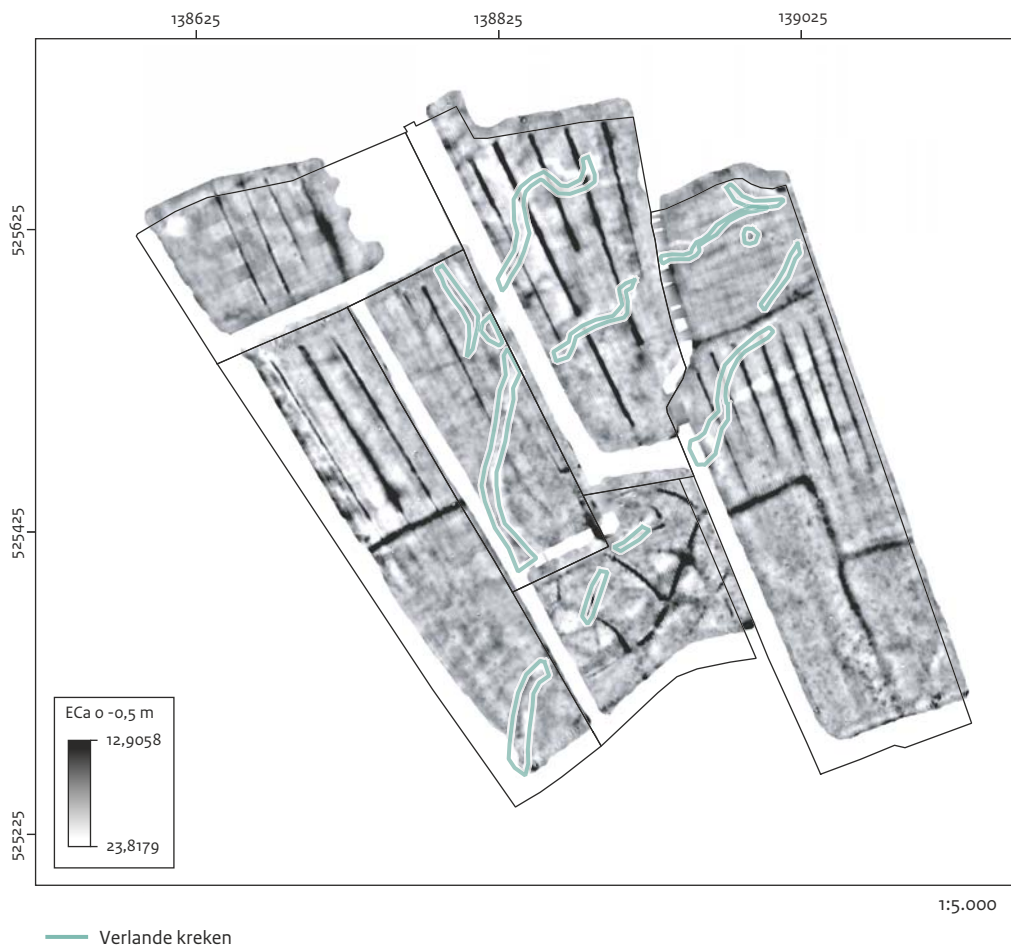
Afb. 11.4 Krekensysteem (fase 1) rijksmonument zichtbaar in de EMI-resultaten.
