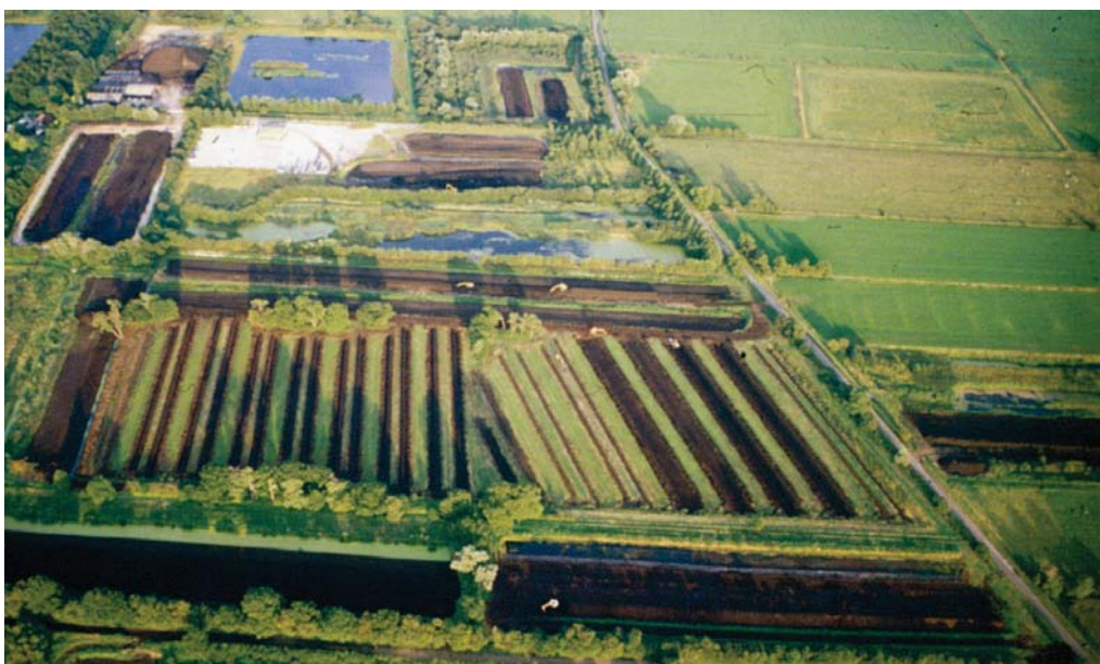
Industriële veenaafgraving bij Godney Moor. Het veen wordt afgegraven tot de onderliggende kleilaag, waarna water wordt ingelaten en het terrein wordt gebruikt als visvijver of voor natuurontwikkeling.
