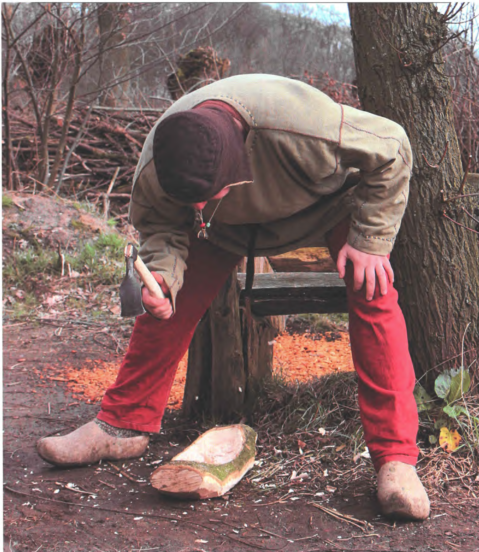
▲ Met een dissel wordt een stuk hout uitgehold om er een bak van te maken.
