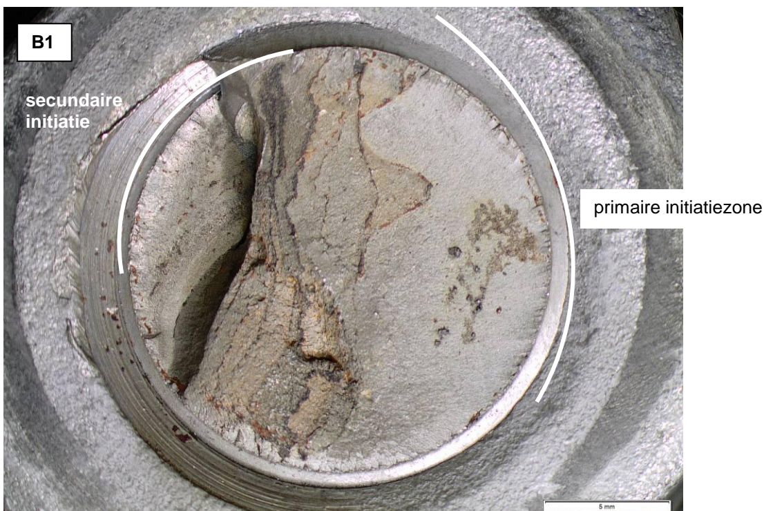
Figuur 7. Bout B1 toonde een breukvlak in twee vlakken. Primaire initiatie is opgetreden langs een groot deel van de omtrek van de bout. Een relatief grote secundaire initiatie had plaatsgevonden in een vlak parallel aan het primaire breukvlak, waarbij de scheuren elkaar deels overlaptten. Beide initiaties vonden plaats vanuit het dal van de draad bij de eerste dragende draadgang van de moer.
