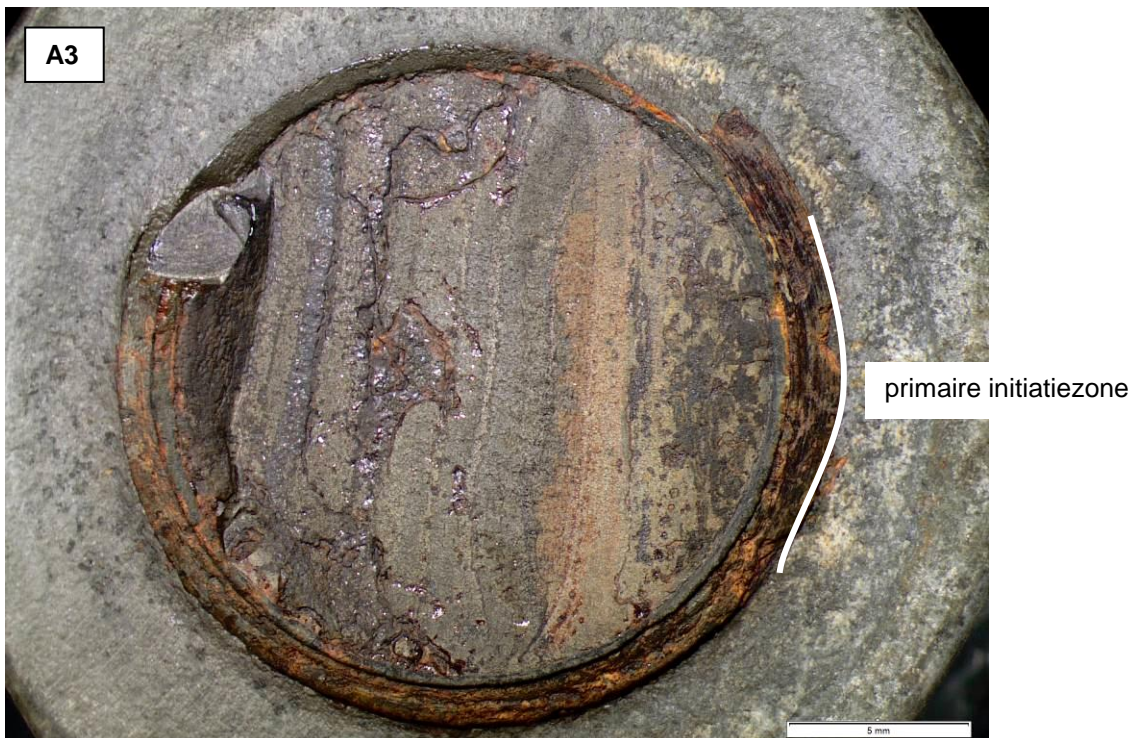
Figuur 6. Bout A3 toonde soortgelijke breukenmerken als bout A1 en A2, maar met een kleinere initiatiezone. Het breukvlak was vlak en toonde een patroon van vrijwel rechte beach marks. Primaire initiatie heeft plaatsgevonden langs een kleiner deel van de omtrek van de bout. In deze zone waren meerdere ratchet marks zichtbaar. Tegenover de primaire initiatie was een kleinere secundaire initiatiezone zichtbaar met aan de rand een kleine taaie restbreuk die aan twee zijden begrensd was door een vermoeingsbreuk.
