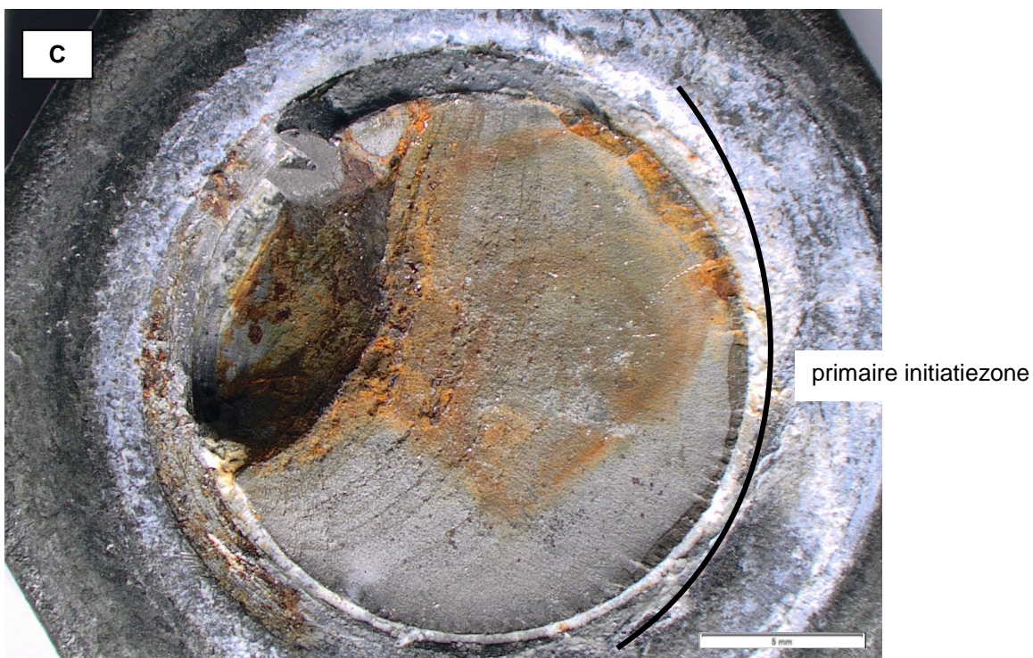
Figuur 9. Bout C toonde in de originele, niet ontroeste, conditie een relatief gaaf en zeer vlak breukvlak met een patroon van beach marks. Initiatie heeft tegelijkertijd plaatsgevonden langs een groot deel van de omtrek van de bout op de positie van de eerste dragende draadgang bij de moer. Tegenover de primaire initiatiezone was een secundaire vermoeiingsinitiatie zichtbaar met aan de rand een kleine taai restbreuk.
