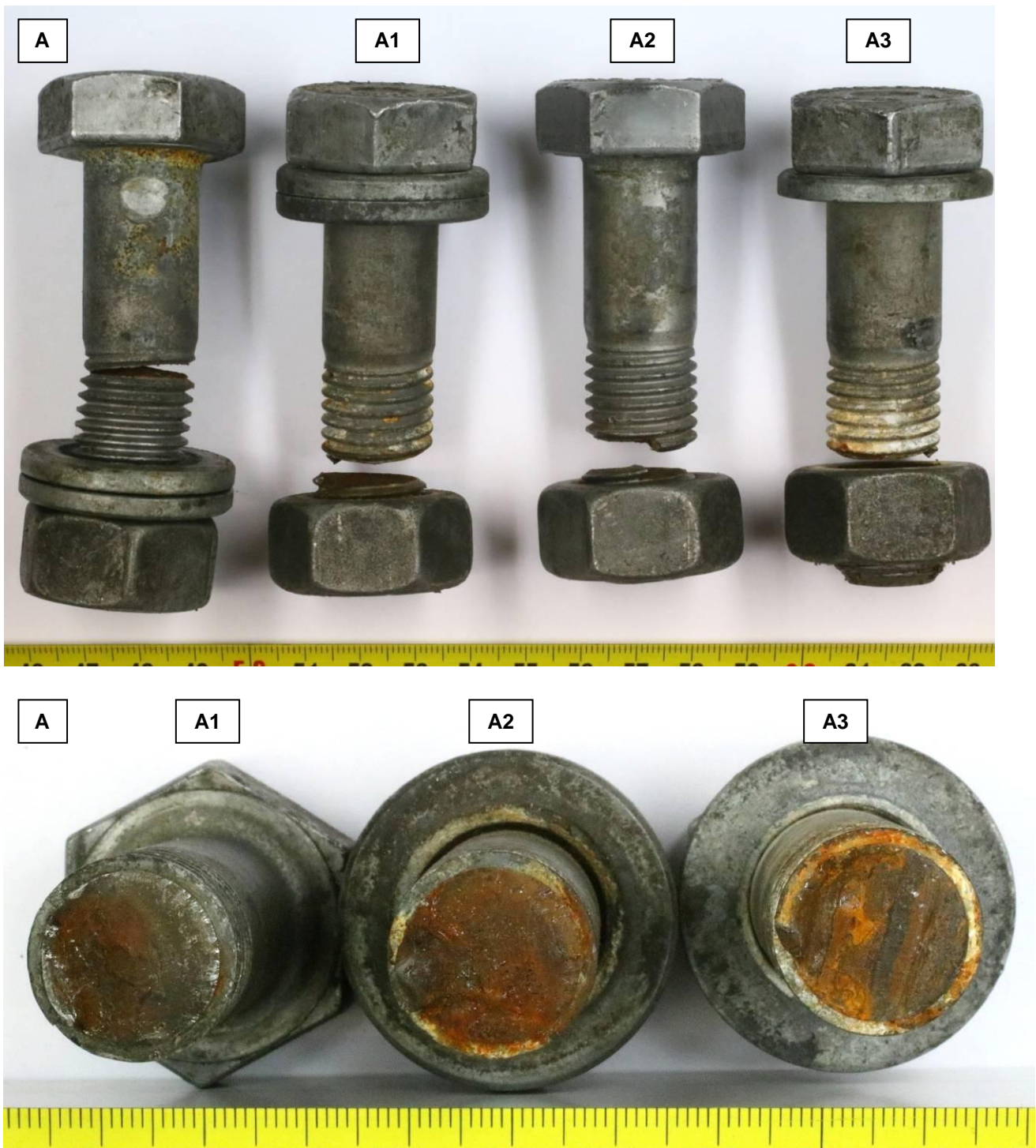
Figuur 1. Van batch A zijn 3 gebroken bouten aangeleverd en één vrijwel doorgescheurde bout. De bouten zijn gefaald op de overgang van de bout naar de moer. In sommige gevallen leek de bout iets verder van de moer gefaald, maar is de moer meest waarschijnlijk na falen en uithalen nog iets verdraaid. De gescheurde bout toonde een openstaande scheur over vrijwel de gehele doorsnede op de overgang van de schacht naar de draad. De scheur liep door het dal van de draad vrijwel haaks op de langsrichting van de bout. De scheur was zeer recht en toonde geen significante deformatie. De breukoppervlakken stonden eveneens haaks op de lengte van de bout en waren grotendeels zeer vlak. De breukoppervlakken toonden meest (rood)bruin corrosieproduct.
