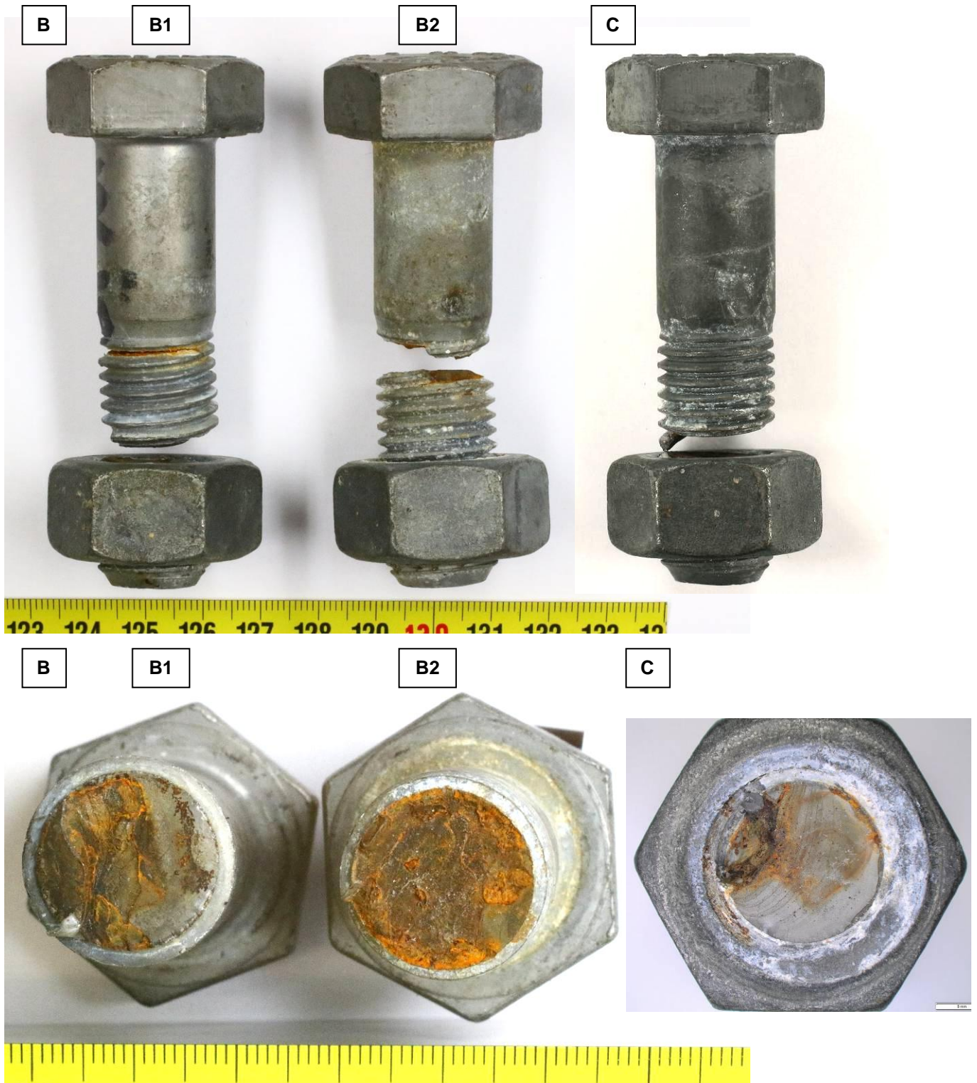
Figuur 2. Van batch B zijn twee gebroken bouten aangeleverd en van batch C één gebroken bout. Bout B1 en C1 zijn gebroken op de eerste dragende draadgang bij de moer. Bout B1 toonde bovendien nog een secundaire scheur op de overgang van de schacht naar de draad. Bout B2 is gefaald bij de overgang van de schacht naar de draad. De breukoppervlakken stonden haaks op de lengte van de bout en waren grotendeels zeer vlak. De breukoppervlakken van de bouten van batch B waren grotendeels bedekt met (rood)bruin corrosieproduct. Het breukoppervlak van bout C toonde veel minder corrosieproduct.
