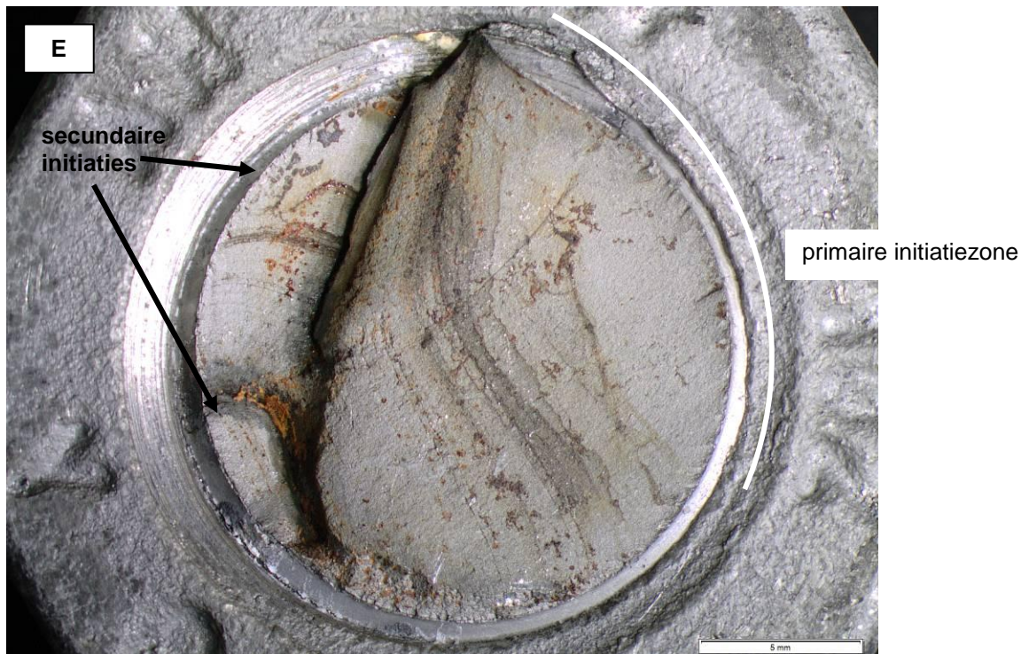
Figuur 11. Het breukvlak van bout E toonde een vermoeiingsbreuk met drie afzonderlijke initiatievlakken. Primaire initiatie vond plaats langs een relatief groot deel van de omtrek van de bout. De secundaire initiaties liggen in andere, deels parallelle, vlakken.
