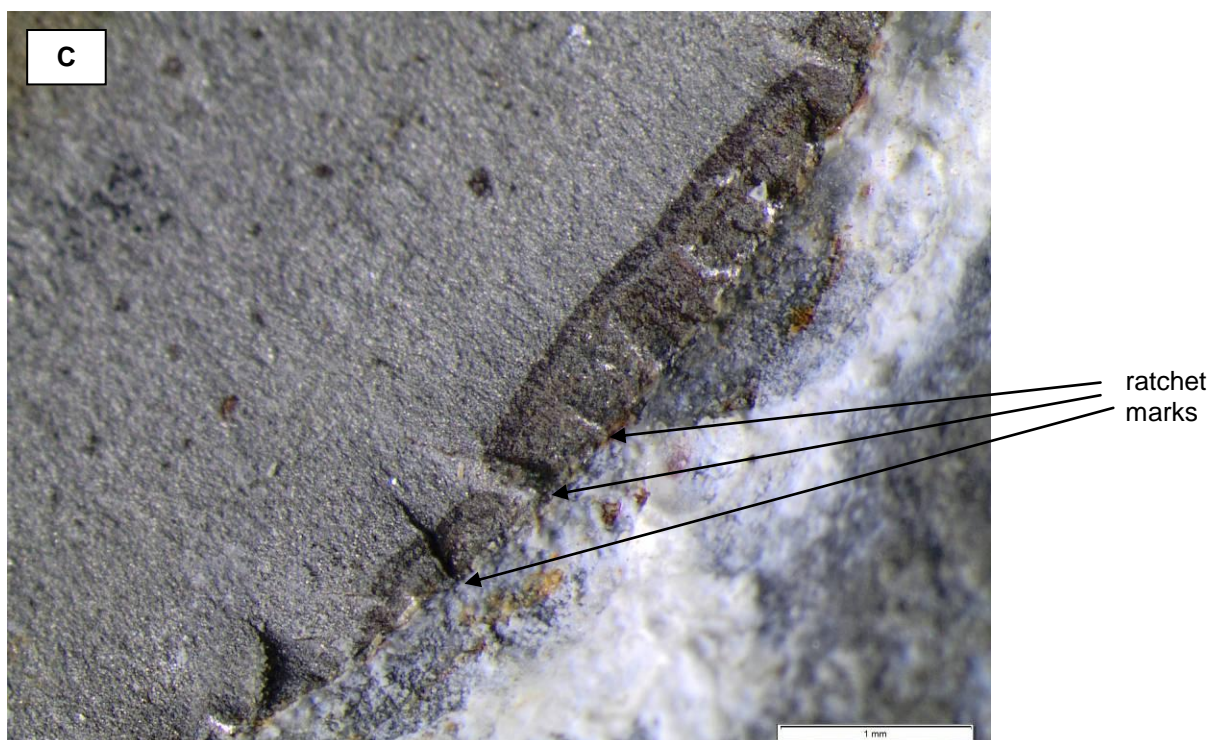
Figuur 13. De structuur van het breukvlak in deze donkere band was gelijk aan de structuur van het aangrenzende breukoppervlak. In de initiatiezone was een groot aantal ratchet marks zichtbaar. Dit geeft aan dat de dynamische spanningen over een groot deel van de omtrek van de bout kritisch genoeg waren om vrijwel gelijktijdig tot vermoeiingsinitiatie te leiden.
