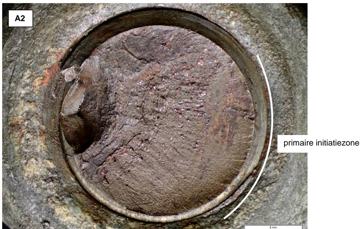
Figuur 5. Bout A2 toonde soortgelijke breukkenmerken als bout A1. Het breukvlak was vlak en toonde een vaag patroon van beach marks. Primaire initiatie heeft plaatsgevonden langs een groot deel van de omtrek van de bout. In deze zone waren veel ratchet marks zichtbaar. Tegenover de primaire initiatie was een kleinere secundaire initiatiezone zichtbaar met aan de rand een kleine taai restbreuk.
