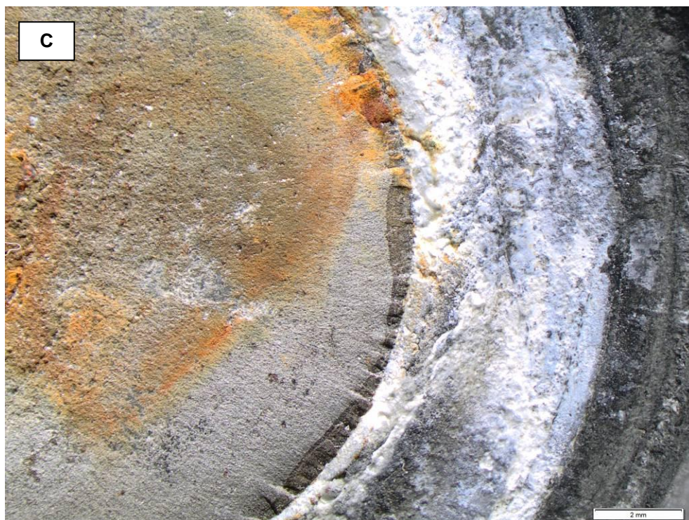
Figuur 12. Het breukvlak toonde relatief weinig corrosie, maar op de rand van de moer was een dikke afzetting van witte zinkroest zichtbaar, met name bij de primaire initiatiezone. Dit duidt op relatief corrosieve condities ter plaatse van de bouten. Op het breukvlak zelf was in de initiatiezone een smalle, iets golvende en relatief donkere band zichtbaar.
