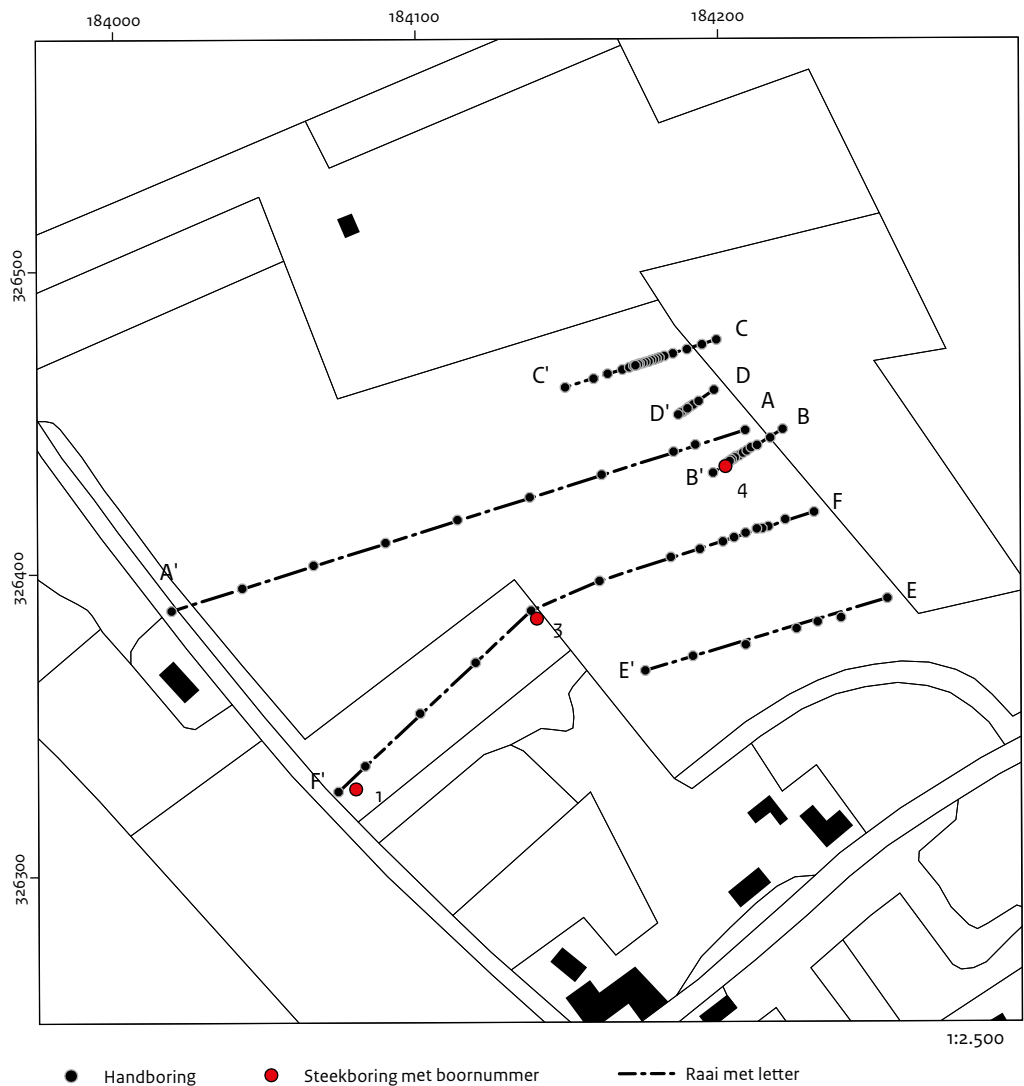
Afb. 6.8 Boorpuntenkaart. De zwarte boringen zijn de handboringen en de rode boringen zijn de mechanische boringen.
