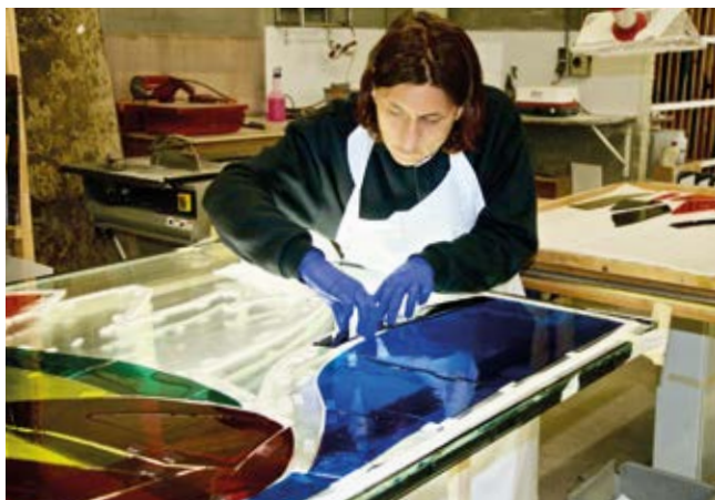
De herstelde stukken glas worden op nieuwe glasplaten gelijmd
