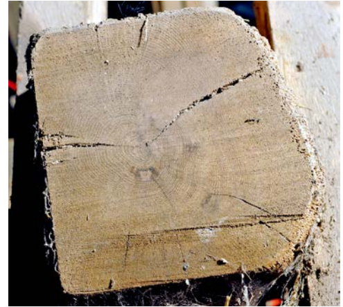
Afb. 6.1 De doorgezaagde bovenste dwarsbalk van gebint 4 bevat een dermate groot aantal jaarringen dat deze geschikt bleek voor een succesvol dendro-onderzoek.
