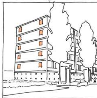
Kopgevels Blinde kopgevels ontbreken, ramen doorbreken het vlak
