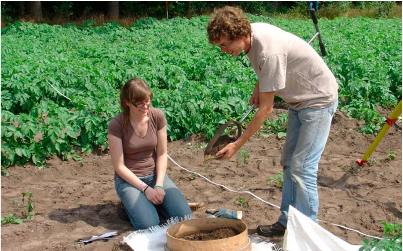
Afb. 3: Booronderzoek met zeefttechniek tijdens het waarderend onderzoek van een vindplaats van de Hamburgcultuur bij Meerveld op de Veluwe. De diameter van de Edelman-boor is 12 cm. Het opgeboorde sediment is handmatig en droog gezeefd over een zeef met een maaswijdte van 3 mm.
