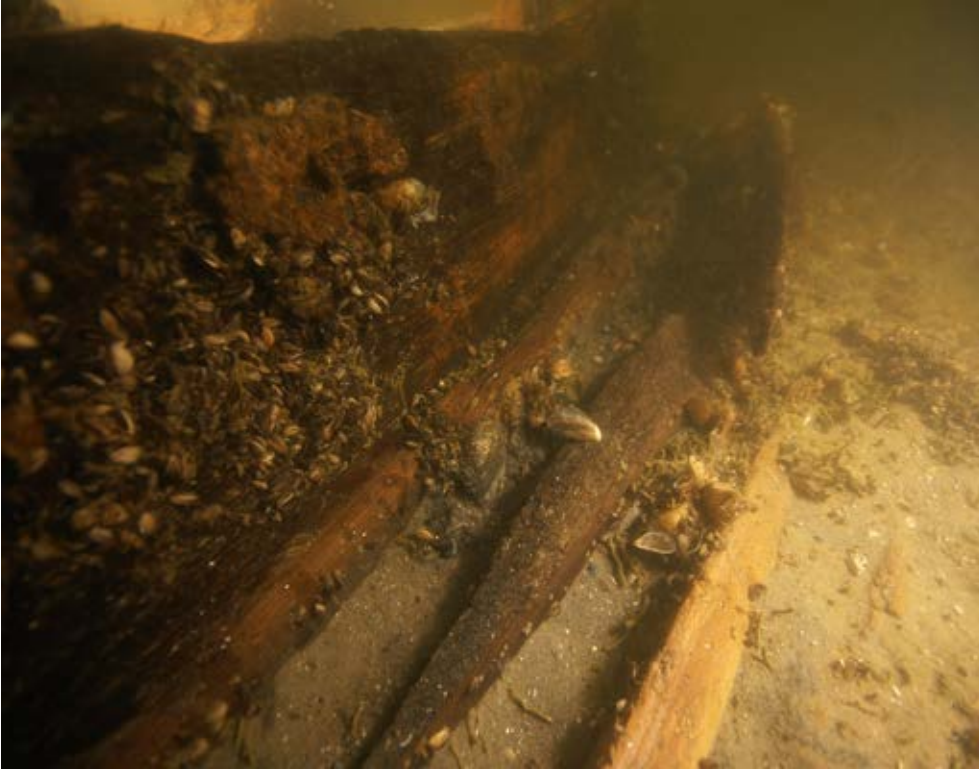
Afb. 4.12: Onderwater opname van de overnaadse huidplanken met breeuwsel in het achterschip (Maritiem programma, RCE).
