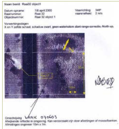
Afb. 3.1: De analoge afdruk van de side scan sonar opnamen van Stavoren 17 (Opname door Stichting Natte Projecten (SNAP)).
