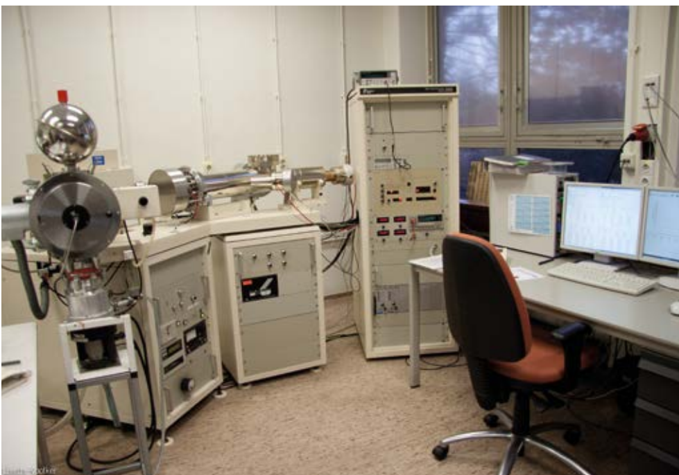
Afb. 4.4 Massaspectrometer (MAT 262), Vrije Universiteit, voor het bepalen van de ^{87}\text{Sr}/^{86}\text{Sr} verhouding. Foto Lisette Kootker.
