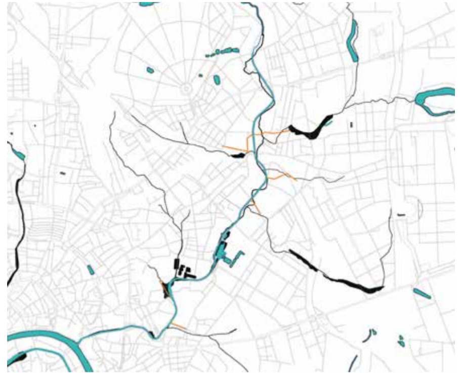
Tekening met zichtbaar de oude loop van de Yauza en de gekanaliseerde nieuwe ligging van rivier en zijrivieren (afb.: Eva Radionova)
