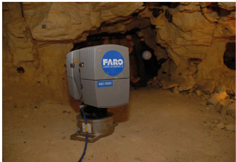
Afb. 3.1 Opstelling van de FARO-laserscanner in de mijn. Op de achtergrond is een van de referentieballen te zien.
