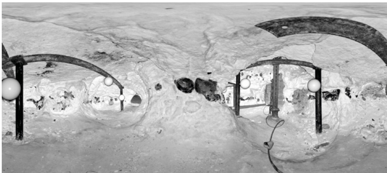
Afb. 3.6 360 gradenafbeelding van 3D-scanopstelling 423, ter hoogte van schacht 2. Op de scan zijn duidelijk de referentieballen te zien waarmee de diverse scans aan elkaar zijn gerelateerd.
