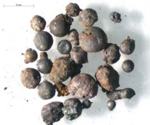
Afb. 5.11 Microscopische opname van hamerslag in een van de monsters uit put 4.
