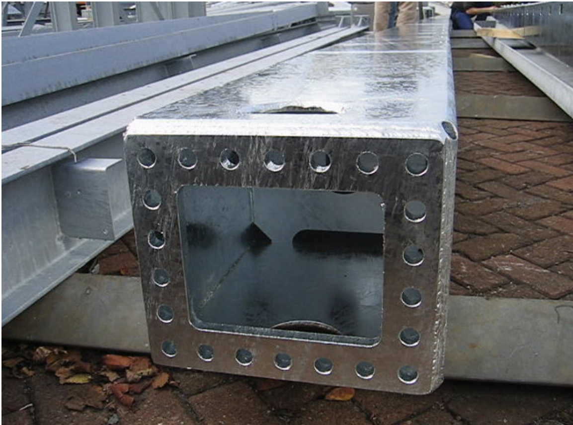
Figuur 8.18: Lekgaten voor uitstromen van zink en water
