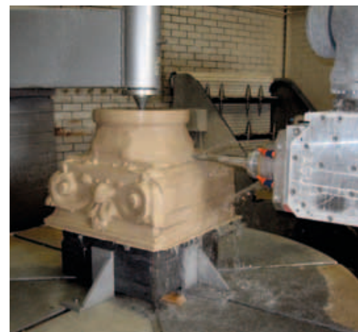
CNC-machines maken de steen exact op maat in bijna elke gewenste vorm
